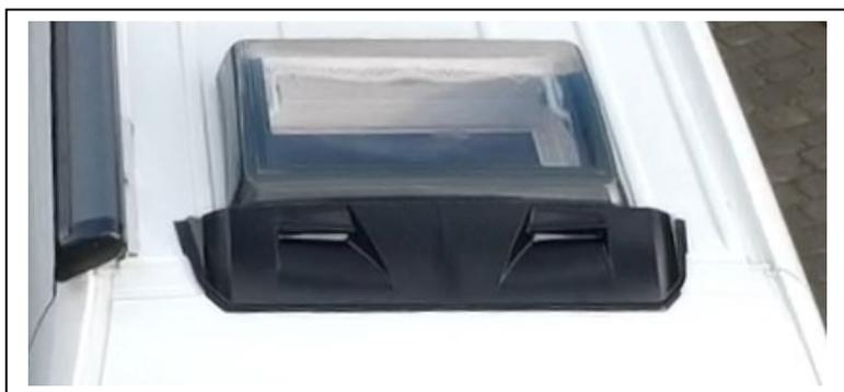
Der Montagekleber sollte bei einer Bezugstemperatur von 20° mindestens 24 Stunden aushärten. Eine niedrigere Temperatur verlängert die Zeit der Aushärtung. Unbedingt Frost bzw. Minustemperaturen bei der Aushärtung vermeiden!
